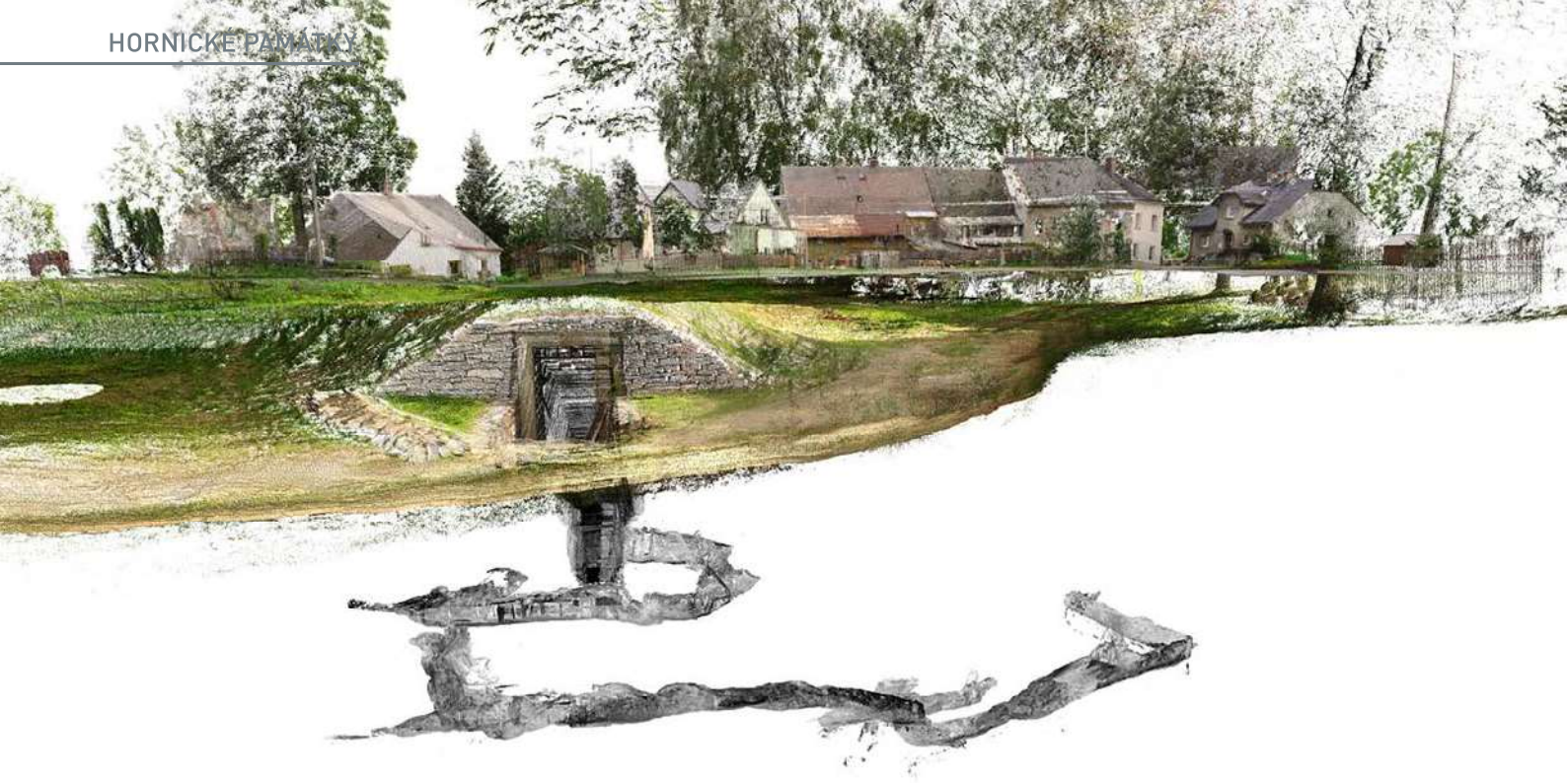
Obr. 4 Výstup ze 3D laserového skenování - reálné zachycení průběhu důlního díla pod povrchem
