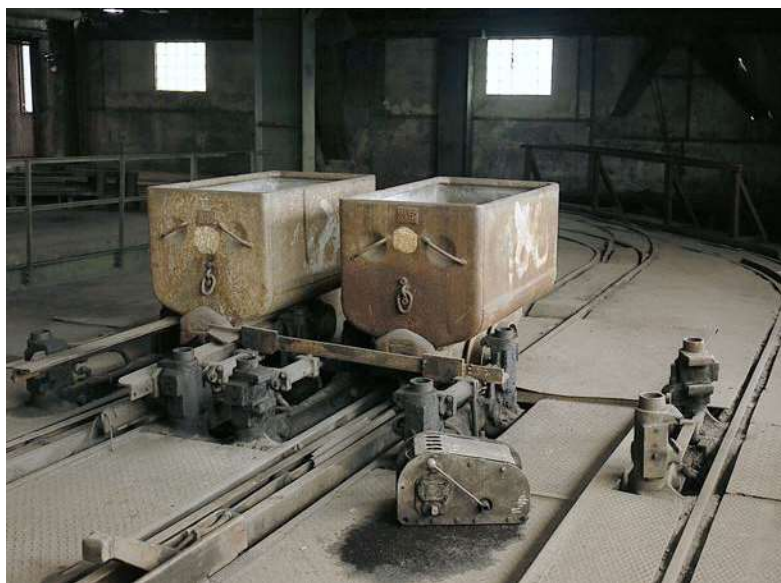
Šachetní budova jámy Jan - nárazí jámy na vozíkovém oběhu s vozy na brzdě, foto: Borský
