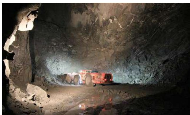
Obr. 38 Dálkově řízené nabírání rudy nakladačem v komoře
