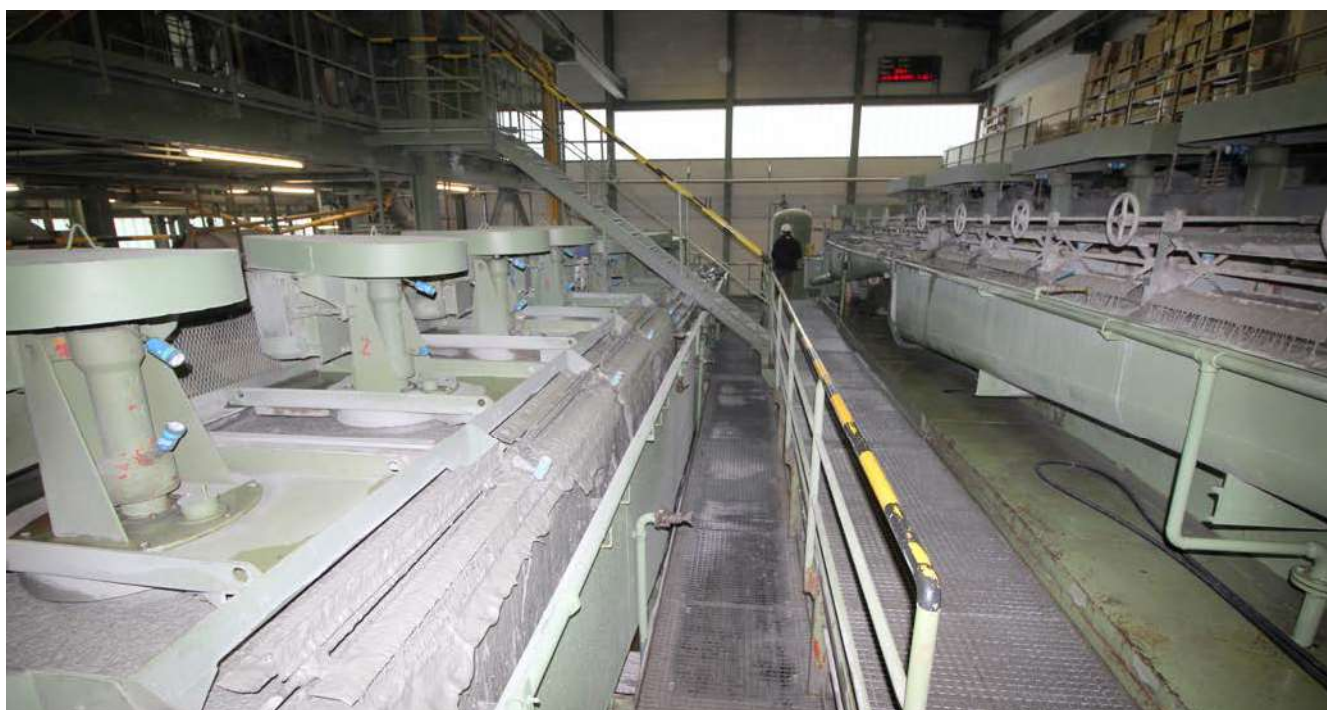
Obr. 39 Flotační část úpravy
