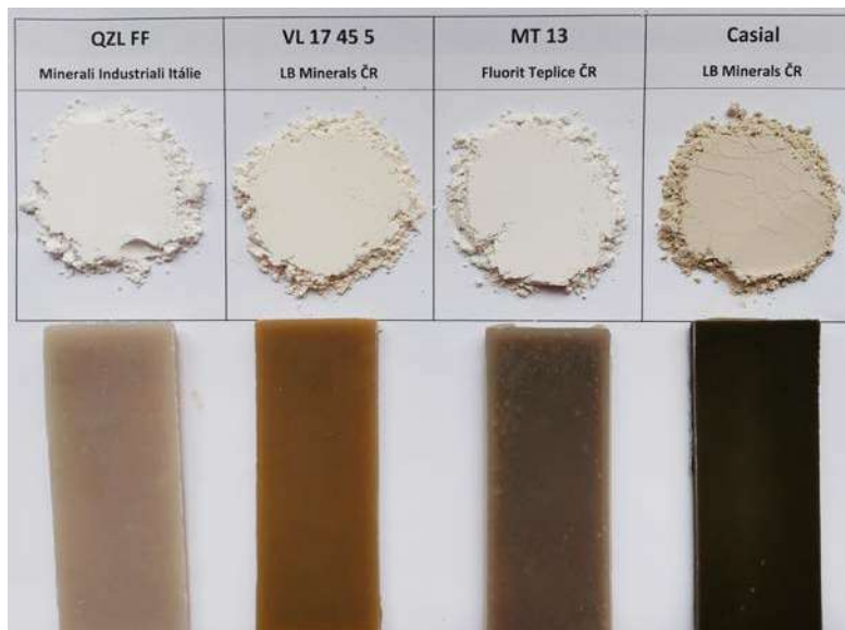
Obr. 28 Vizuální porovnání mikromletých plniv využívaných v Technistone
