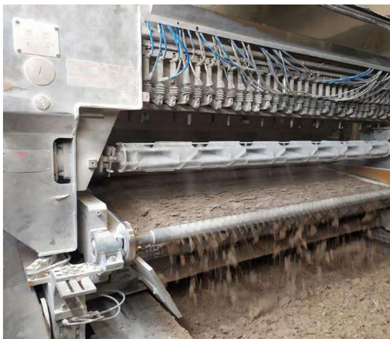
Obr. 42 Dávkování pigmentových směsí pomocí technologie GEV
