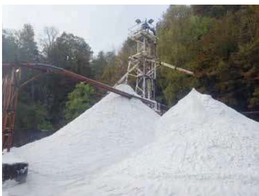
Obr. 13 Skládka čisté suroviny s gravitačním odvodněním
