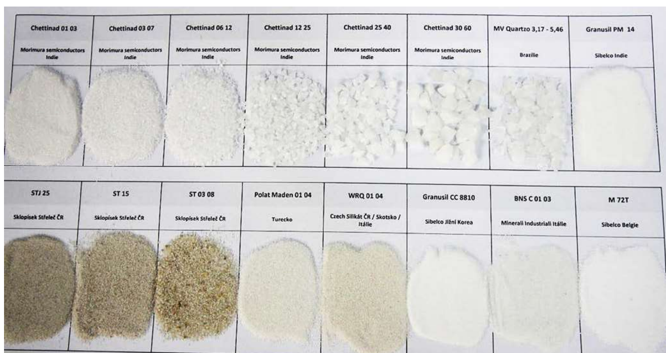
Příklady granulátů na bázi křemene a cristobalitu.
