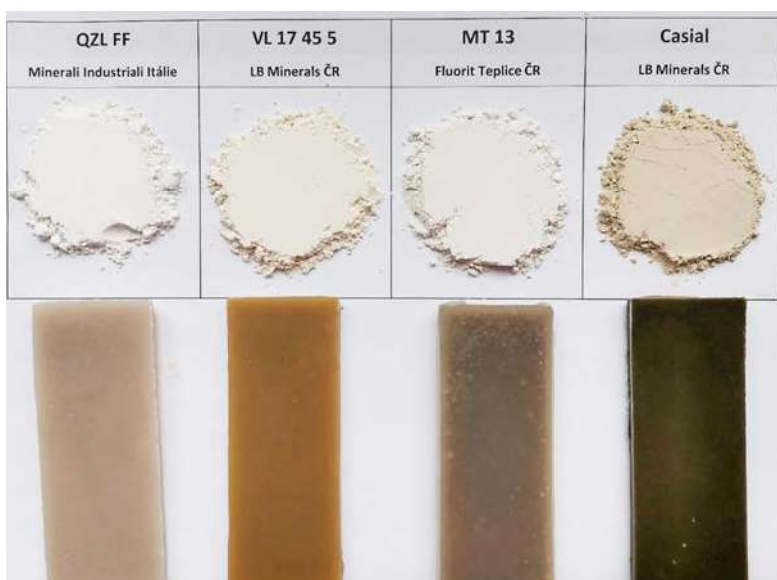
Příklady používaných typů mikromletých plniv v práškové formě i ve formě zkušební destičky pro měření barevnosti. Foto JA.
