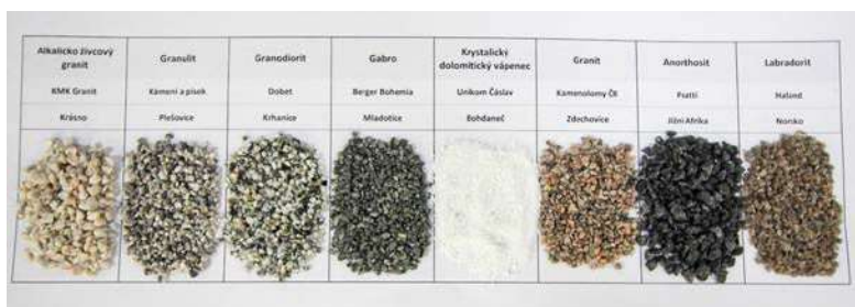
Příklady granulátů na bázi horninových drťí.
