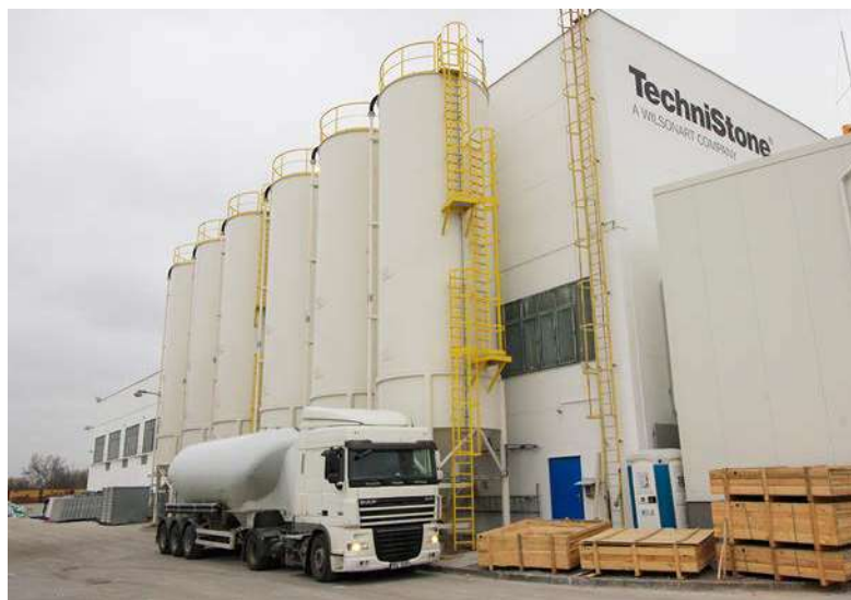
Stáčení suroviny z autocisterny do sila.
