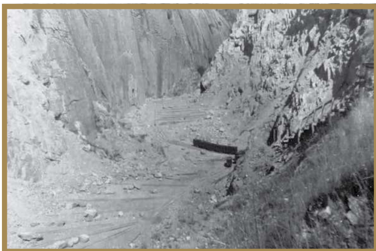
Využívání důlních souprav k těžbě vápence v lomu Východ (Velká Amerika).
