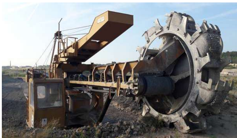
8. Kolesové rypadlo k těžbě jííl ložiska Borovany – Ledenice. (Foto – J. Zahradník)
